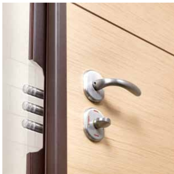
Cierre automático de la puerta gracias a la cerradura motorizada, que se acciona cada vez que el resbalón de la cerradura entra en su alojamiento. Gracias a este sistema, los cerrojos están siempre accionados.
