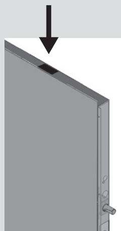
El sensor del dispositivo está calibrado para activar el sistema exclusivamente en caso de un intento de entrada forzada.
